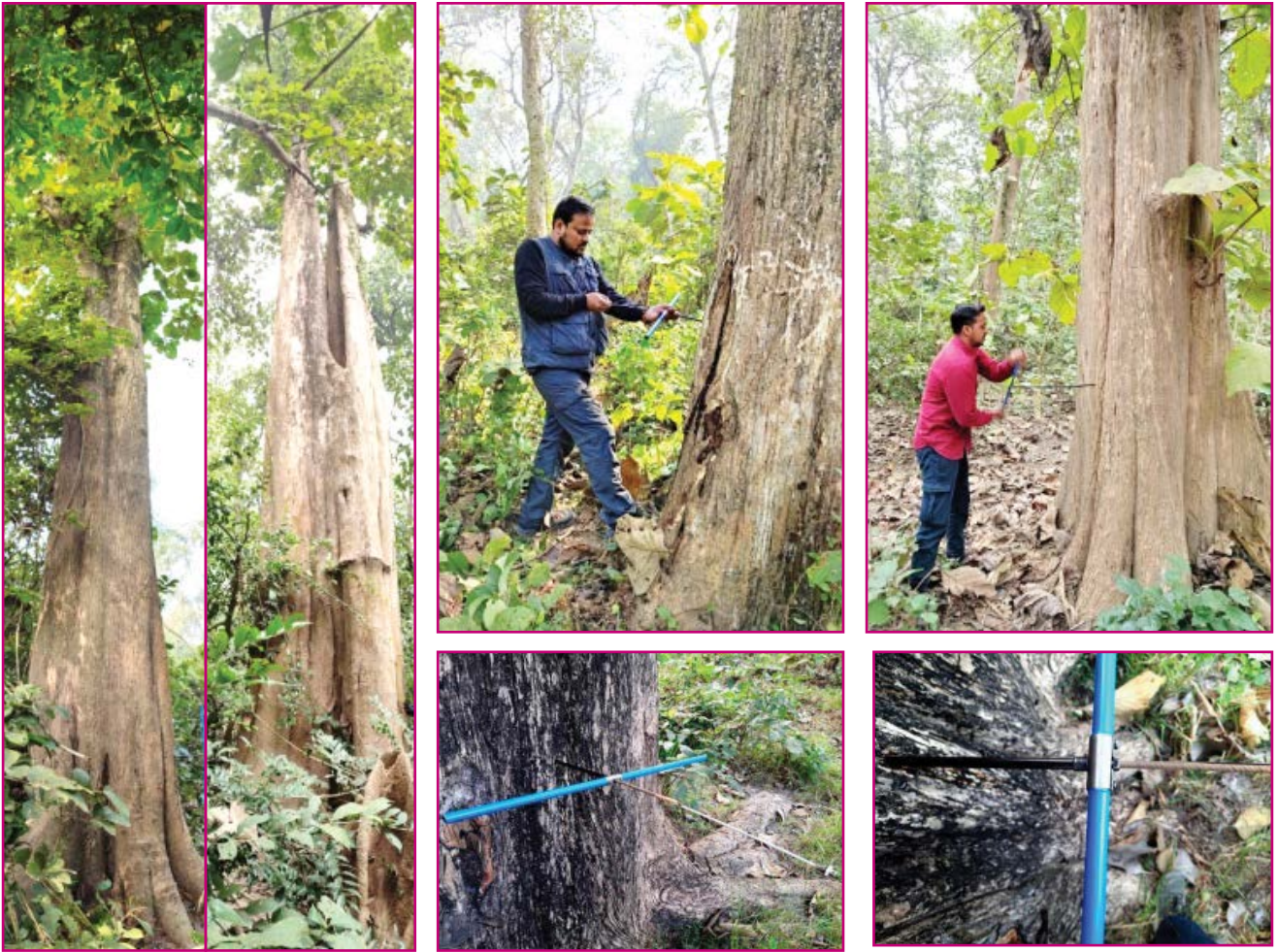
आकृति 7 – इंक्रिमेंट बोरर का उपयोग करके उत्तर प्रदेश के महाराजगंज जिले से वृक्ष वलय क्रोड (टेक्टोना ग्रैंडिस) का नमूना संग्रह।
